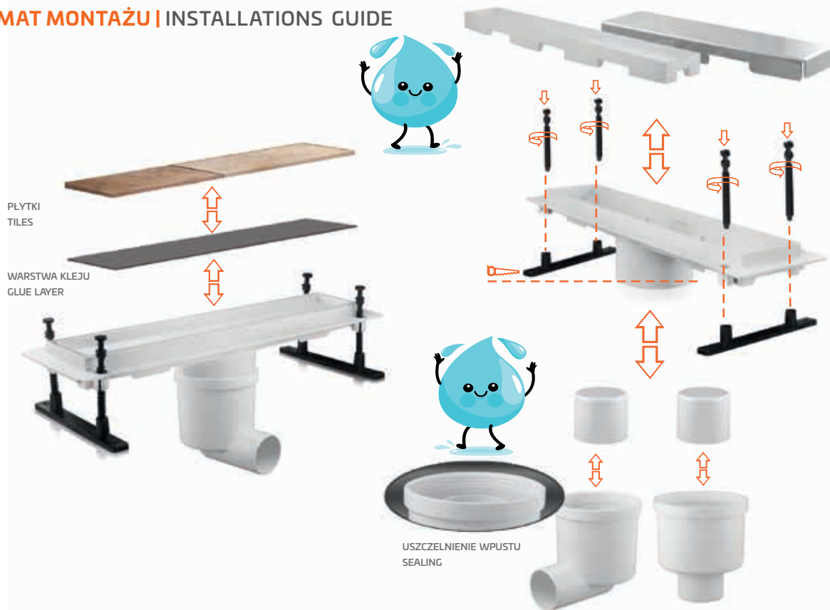
8 02205 600X80 WPUST Z ODPLYWEM BOCZNYM Z METALOWĄ KRATKĄ FLOOR DRAIN WITH HORIZONTAL OUTLET AND STAINLESS STEEL GRATING
